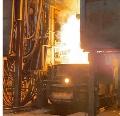
Abbildung 2.95: Eintauchvorgang der Briketts in die Schmelze.
