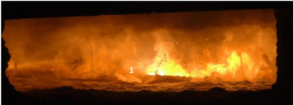
Abbildung 2.96: Blick in den Ofenraum mit Briketts auf der Oberfläche der Schmelze (1).
