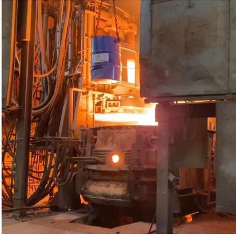
Abbildung 2.94: Chargierung der Briketts in die Schmelze im Elektrolichtbogenofen.
