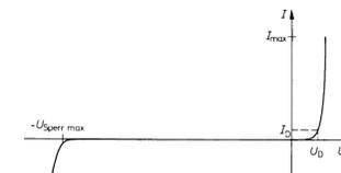
Abbildung: Kennlinie Diode
